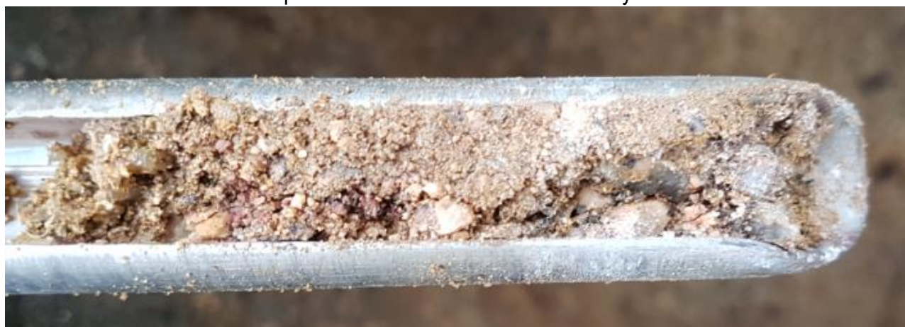
přechod eluvia do silně zvětralé žuly
