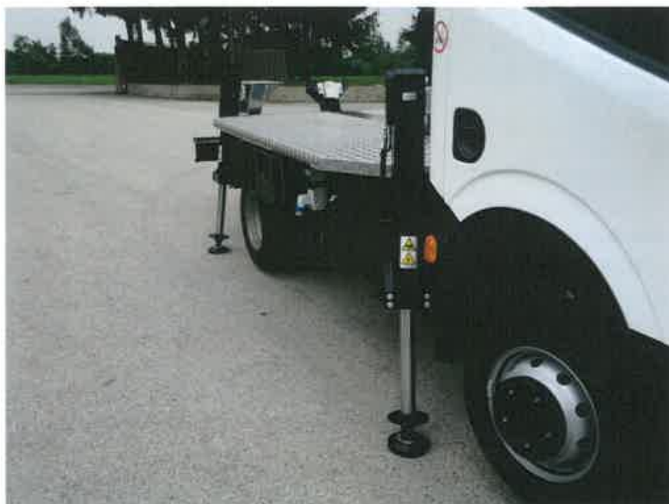
Obr. stabilizace pomocí podpěr - vysouvají se pouze směrem dolů a nepřesahují obrys vozidla.
