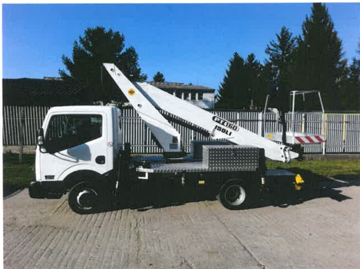
Obr. PT160 na podvozku Nissan Cabstar s rozvorem 2900 mm - plošina má velmi malé transportními rozměry.
