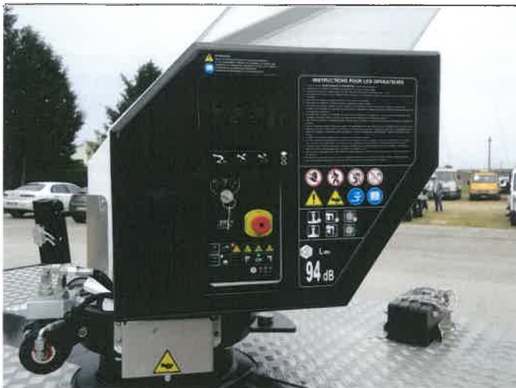
Obr. ovládání na spodním stanovišti a držák se stabilizačními podložkami.
