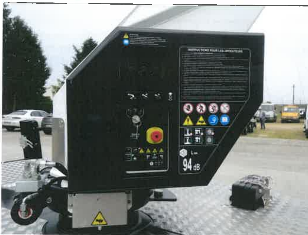
Obr. ovládání na spodním stanovišti a držák se stabilizačními podložkami.
