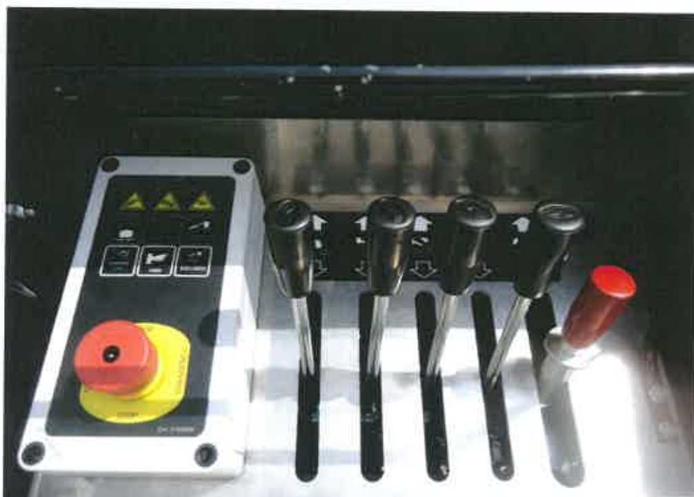
Obr. ovládání v pracovní kleci - proporcionální hydraulický ovladač umožňuje více pohybů plošiny najednou a zaručuje plynulost pohybů ramen.
